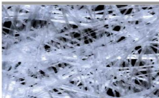
除玻璃纖維外，還有玻璃球，金屬氧化物（氧化鈦，氧化鉻），碳酸鈣，二氧化矽成分（砂沙，石英），陶瓷等複合材也會造成模面磨耗
